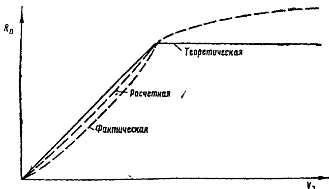
Фиг. 247. Теоретическая, расчетная и фактическая характеристики амортизатора
